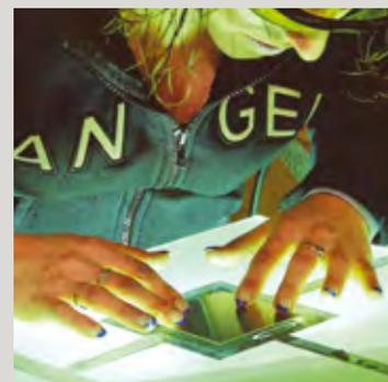
Les éléments de décors sont placés entre double-vitrage. Un filet transparent est préservé autour des pièces pour éviter d'être taché par la colle.
