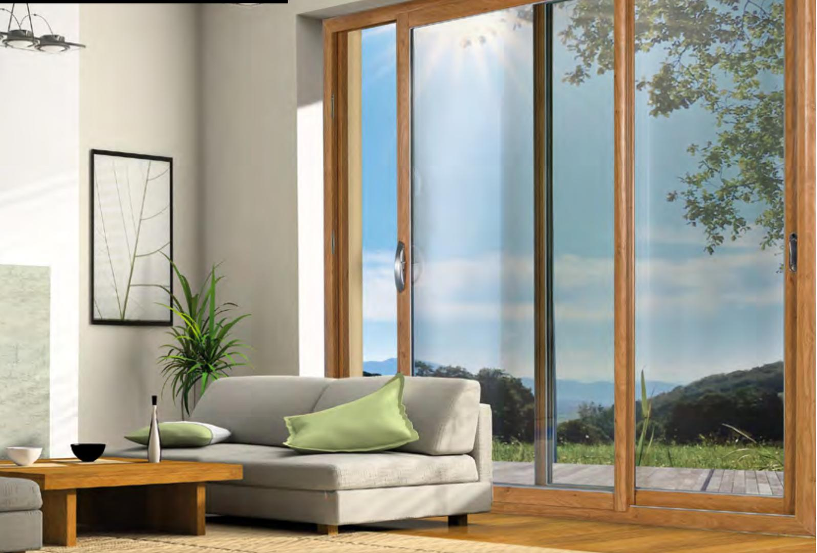
**TWINÉA GAGNE EN ESTHÉTIQUE ET EN CLAIR DE VITRAGE GRÂCE À UNE RÉDUCTION SIGNIFICATIVE DE LA SECTION DES MONTANTS.**
