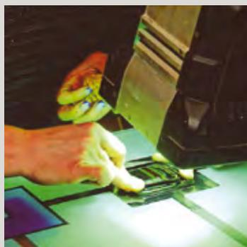
La colle est durcie avec une lampe à ultraviolets. Elle restera invisible, stable et neutre.
