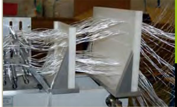
Le renfort obtenu est incorporé au cœur du PVC, permettant ainsi une rigidité renforcée du profilé.
